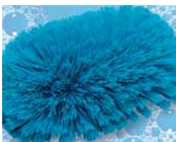
Les filaments sont enchevêtrés en raison d'une longue utilisation: le produit doit être remplacé.
