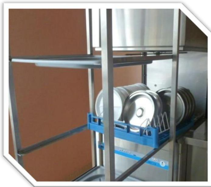
Positionnement des paniers sur l'échelle pour la finition séchage de la vaisselle.
