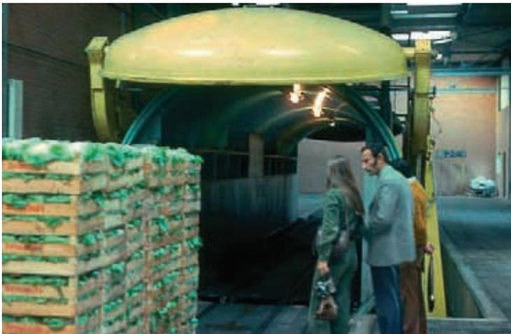
**Figure 57: Refroidissement par vide d'air. Chacun des deux côtés de la glacière sont soulevés afin de pouvoir placer le produit à l'intérieur et ensuite refermés pour permettre un vide d'air à l'intérieur.**
