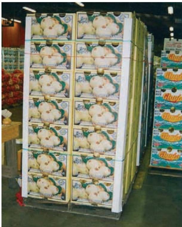
Figure 47: Stabilisation de palette avec système de protection des angles et sangles.
