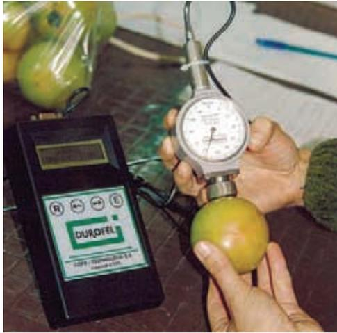
Figure 12: Mesure objective de la fermeté.
