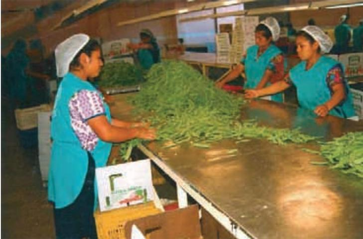
**Figure 37: Système de triage de qualité statique. Les produits sont déposés sur une table où les éléments défectueux sont enlevés.**
