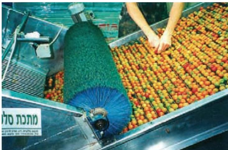
**Figure 32: Brossage et tri manuel des fruits endommagés avant calibrage.**
