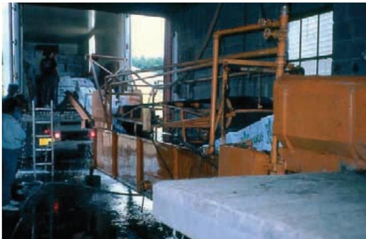
Figure 56: Produits sujets à hydro-refroidissement et chargement direct dans le camion.
