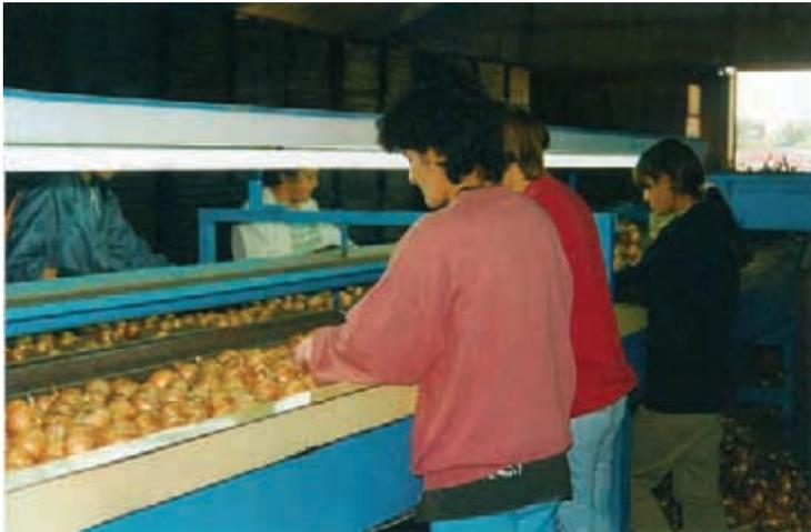
Figure 25: L'éclairage au niveau des yeux est source d'éblouissement et de fatigue visuelle. De plus, il est nécessaire de couvrir les sources lumineuses de façon à éviter, en cas de dommage, que les bris de verre ne se déposent sur les produits.
