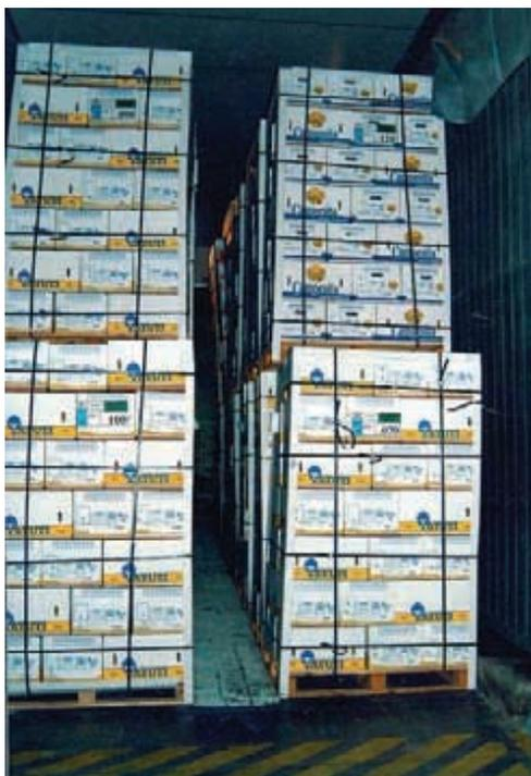
**Figure 55:** Intérieur d'un lieu de circulation à air forcé. Les palettes sont arrangées de manière à former une aile entre elles et le haut recouvert d'une toile, ce qui laisse les deux côtés exposés à l'air froid. L'air du tunnel de répartition est rejeté, créant une pression négative forçant l'air à passer à travers le chargement.
