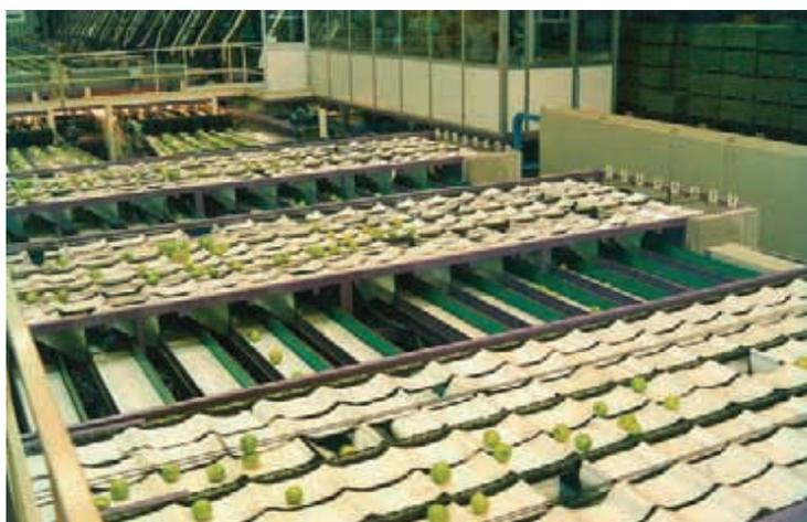
Figure 36: Triage en fonction du poids. Des plateaux individuels déposent les fruits sur le tapis roulant correspondant.
