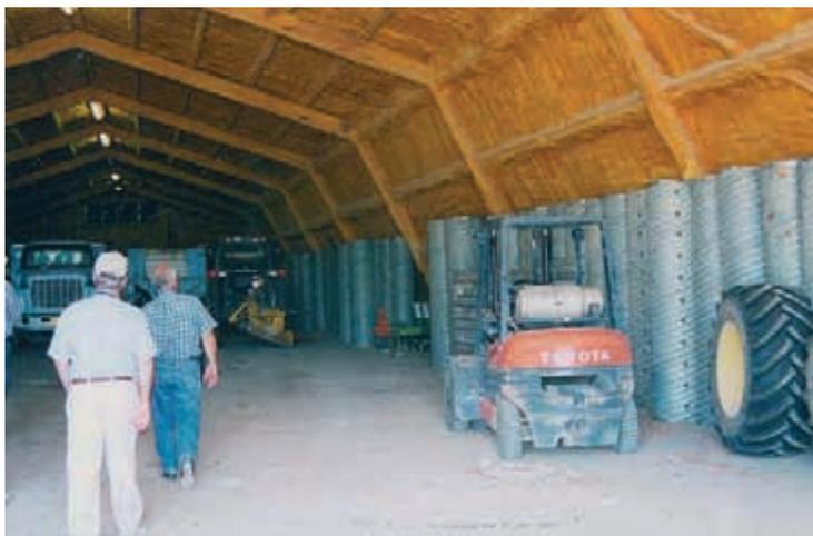
**Figure 52: Intérieur d'un lieu de stockage à circulation d'air forcé. Les conduits d'air sont retirés et les espaces vides sont utilisés afin d'abriter les machines agricoles et l'équipement si aucun produit n'est stocké.**
