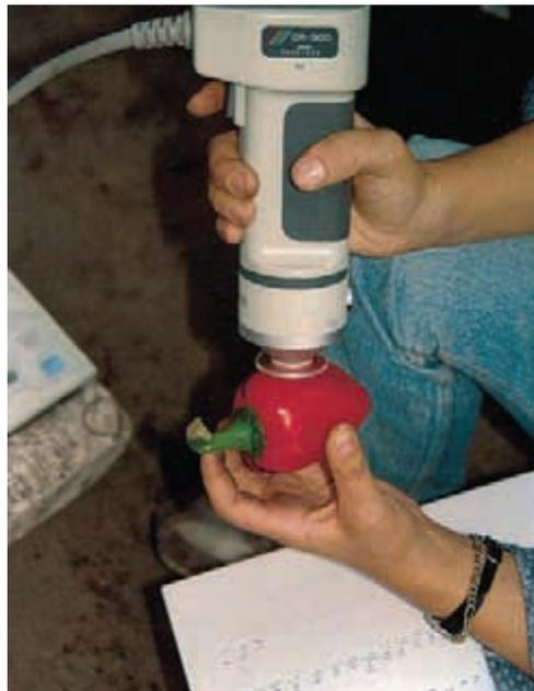
Figure 7: Mesure objective de la couleur avec un colorimètre.
